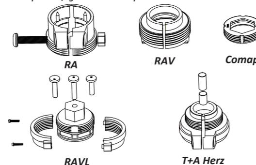
**Étape 3: Installer la plaque de montage du thermostat.** Retirer la plaque de montage du thermostat (Partie 1) dans l'image ci-dessous) Dans le sens contraire des aiguilles d'une montre
